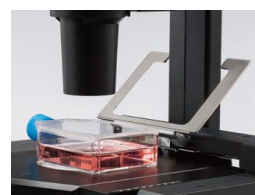
各種容器を保持でき、必要時に退避できるリトラクティブホルダー
